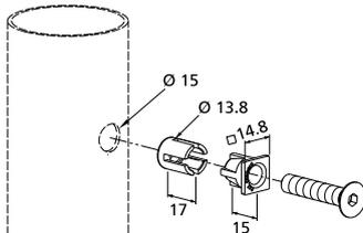
**60.7200.9245****60.7200.9245****Befestigungsteile QUICK-FIX**zu Schliesskasten für Profile Rundrohr und 4-kant-Rohr
