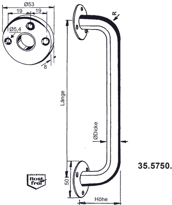
**Handhaben aus Edelstahl 1.4301, matt, für Einzel-Montage mit fester Grundplatte, mit 3 versenkten Anschraubloch für M5 Schrauben, mit mitgelieferten Abdeckrosetten ohne Loch zum aufklipsen, für ein sauberen Abschluss. Ohne Schraubenlieferung.**
