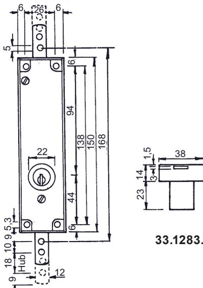
**Stangenschloss mit Stangenantrieb über den**
