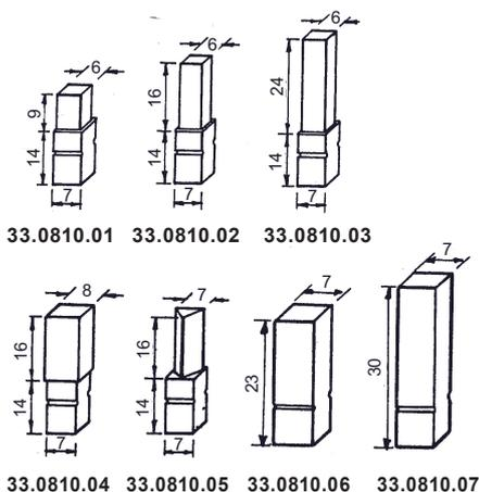
**Einpressdorn mit Kerben, zum Einpressen**
