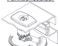
Durch 90° Drehung der Betätigung wird die Zunge hinter die Schließfläche gebracht, die Tür kann nicht mehr geöffnet werden.
