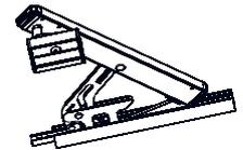
**GEZE Scheren OL 90 N mit 1 Stangenführung**
