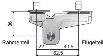
**ANCA-Aluminium-Bänder, 2-teilig/3-teilig**, mit dreidimensionaler Verstellung (Höhe, Seite und Andruck). **Drehpunkt 36 mm, Stichmass 62,5 mm (57,5-67,5 mm)** ist auf das jeweilige Türprofil abzustimmen. Ein gewaltloses Lösen oder Entfernen des Bandes bei geschlossener Tür ist nicht möglich (Einbruchsicherheit). Ohne Befestigungsmaterial, ist gesondert zu bestellen.
