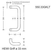
aus hochwertigem Polyamid, Achsmaß 300 mm.
