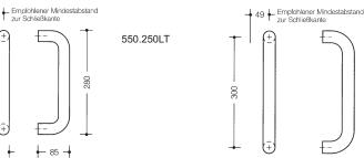
85 -HEWI Griff ø 33 mm aus hochwertigem Polyamid, Achsmaß 300 mm.
