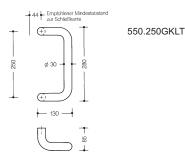
HEWI Griff ø 30 mm aus hochwertigem Polyamid, Achsmaß 250 mm.
